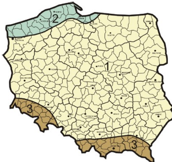
Rys. 2. Podział polski na strefy obciążenia wiatrem wg. PN-EN 1991-1-4.
